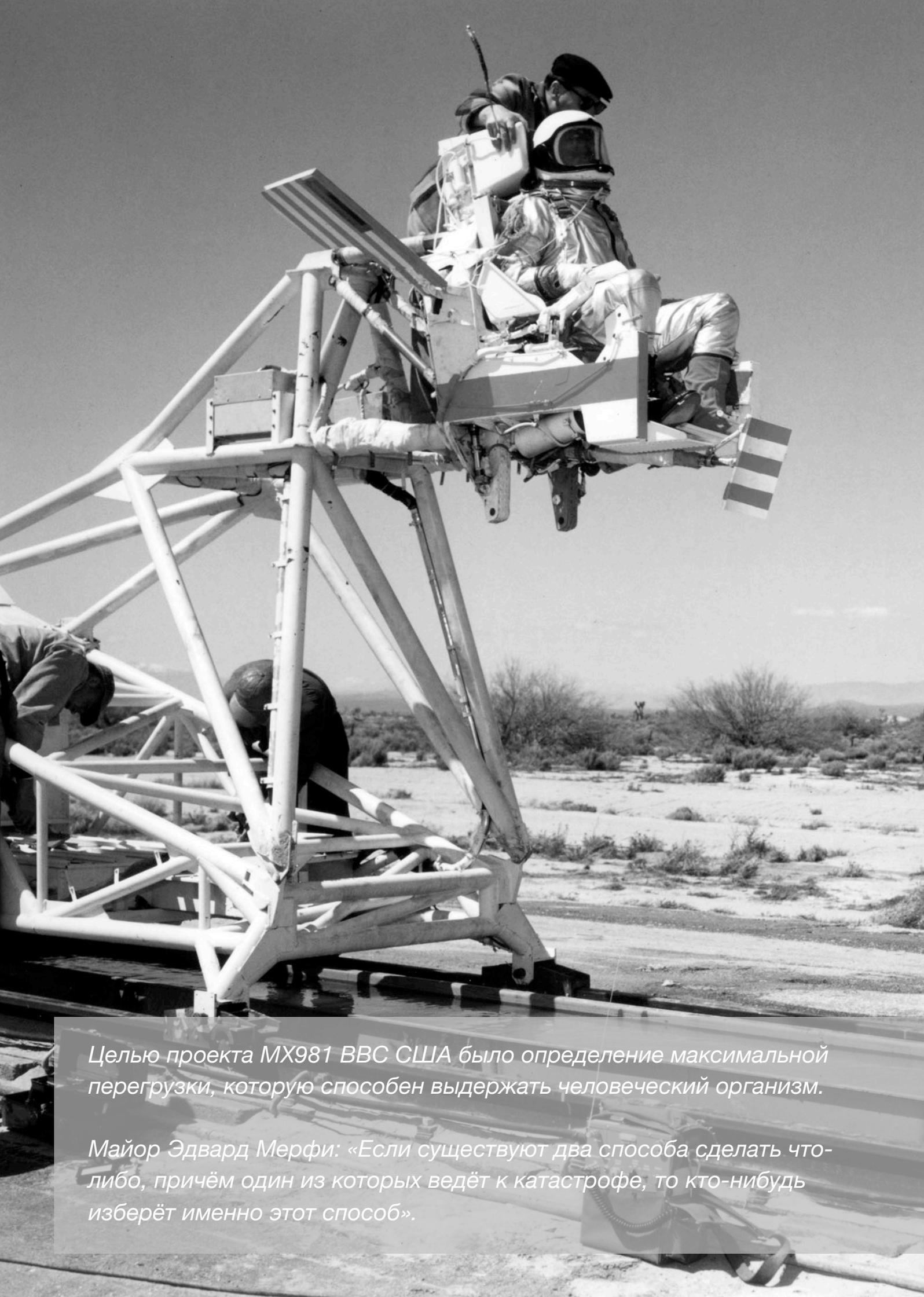
*Целью проекта MX981 ВВС США было определение максимальной перегрузки, которую способен выдержать человеческий организм.*
